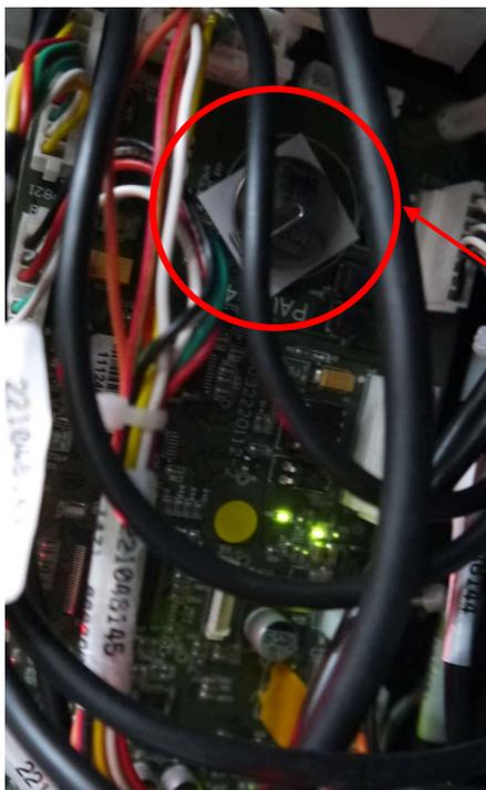
Cortar la soldadura y retirar la pila
