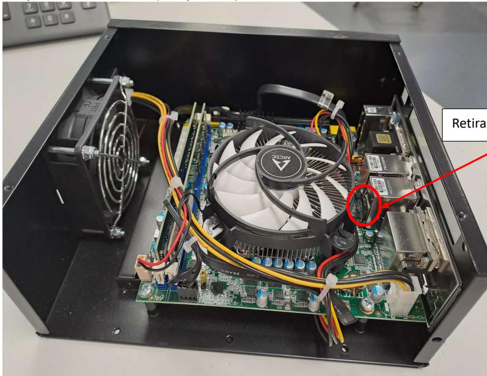
Retirar la pila del zócalo
