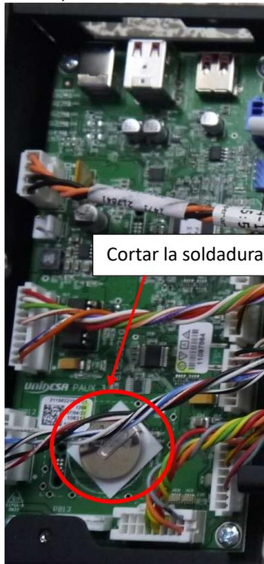
Cortar la soldadura y retirar la pila
