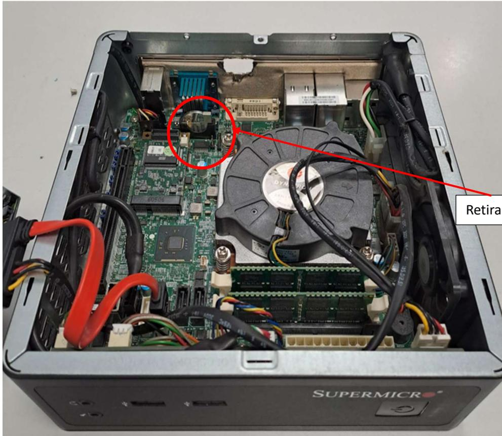
Retirar la pila del zócalo
